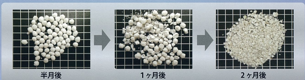
【粒崩壊の様子】
